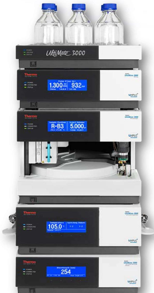
通过共享自动进样器、柱温箱、色谱数据系统实现两套分析系统的功能。无论是常规分析、微量分析或纳升级分析，双三元系统均能提供完美的解决方案。
