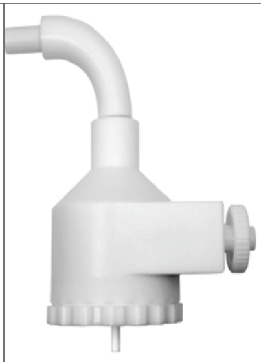
图二 耐氢氟酸雾化器和雾化室
