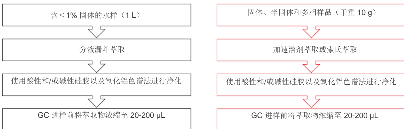
图 1. 水、固体、半固体和多相样品的样品制备流程
