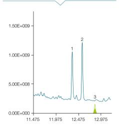
精确质量下得去卷积功能分别提取高浓度和痕量级组分,提取样品的干净质谱图和全面信息。图中显示 TIC 中的主峰(1-2)和绿色部分的微量组分(3)。
