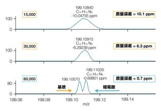
分辨力在15K、30K和60K分辨率下韭葱中10 μg/Kg嘧霉胺质量精确度的影响。要从基质干扰中分离嘧霉胺,以达到与监管指令相符的质量精确度 (<5ppm), 60K的分辨率才能达到要求。
