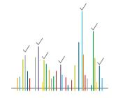
高分辨过滤因子 (HRF) 算法基于质谱中每个离子的元素组成使用精确质量信息排除不大可能成为候选化合物的化合物。该算法可为检测到的组分执行高置信度的鉴定。
