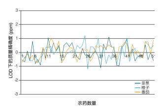
韭葱、橙子和番茄基质中 51 种农药,在超大残留限量  $(0.5-5~\mu g/Kg)$  下的质量精确度。一致的低质量误差可为 阳性鉴定提供充分的自信。
