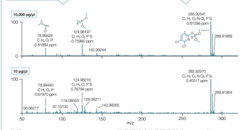
使用 Thermo Scientific<sup>™</sup> Mass Frontier<sup>™</sup> 软件通过碎片分配分别对 10,000 和 10  $pg/\mu$ l 甲基毒死蜱的全扫描数据进行分析。无论是低浓度还是高浓度,在整个质量范围内保持良好的匹配和低于 1 ppm 的质量精确度。
