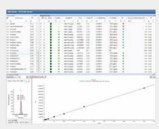
TraceFinder 软件使用 Exactive GC 系统采集的数据,同时结合化合物检测、鉴定和定量,实现常规痕量农药分析,以确保符合法规指令要求。此外,该软件还可结合灵活的报告工具模板为检测到的化合物执行自定义、自动标记的功能。
