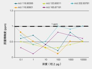
在六个数量级上六氯乙烷离子的质量精确度(柱上0.1~10,000 pg)< 1 ppm。在痕量级和高浓度水平始终维持高品质质量数测定值。
