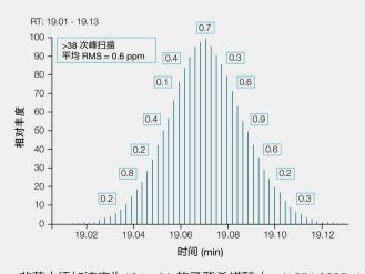
韭葱中添加浓度为10 μg/Kg的乙酯杀螨醇(m/2 251.0025 ±5 ppm质量窗口)提取离子色谱图,显示超过38 次扫描/峰(峰宽 6 s)。数据在60K FWHM分辨力下以全扫描模式获得。每次单独扫描均获得优异的精确质量(ppm)(每第三次扫描标记一次)。峰上的平均 RMS 质量差异为0.6ppm。
