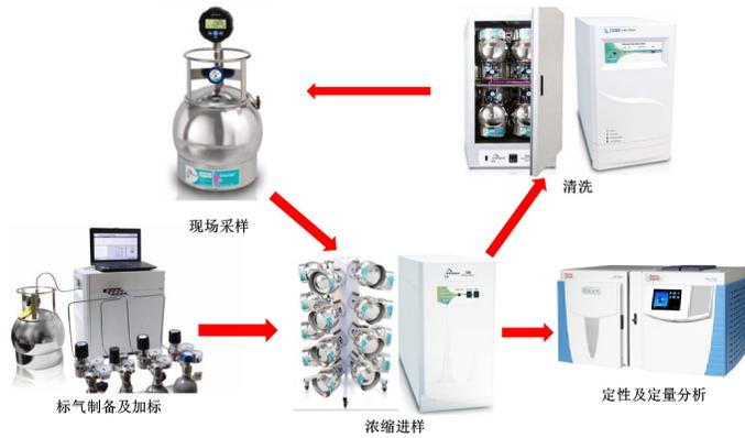
图 1. 罐采样系统测试流程示意图
