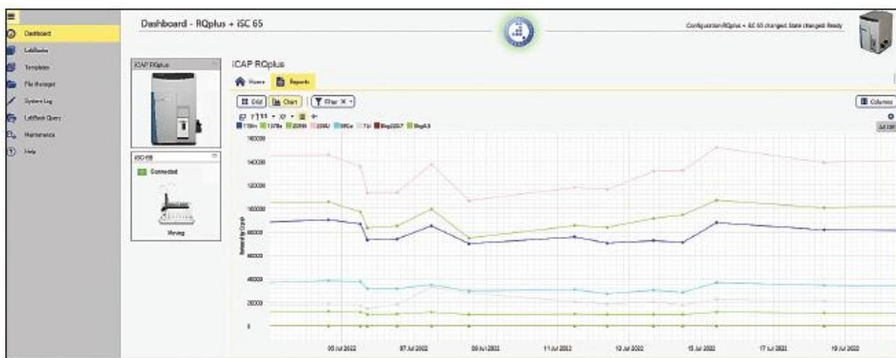
图 1.整个研究期间 iCAP RQplus ICP-MS 仪的灵敏度性能图
