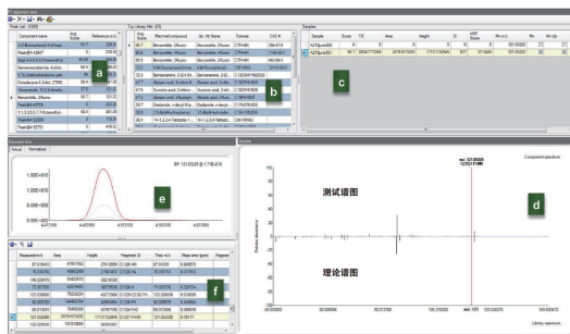
图 2. 应用 TraceFinder 软件对 4-甲基吗啡样品中的杂质进行检测和鉴定的示例。通过结合 TIC 谱图卷积、谱库检索、HRF 评分以及其他标准实现智能化化合物鉴定流程。
