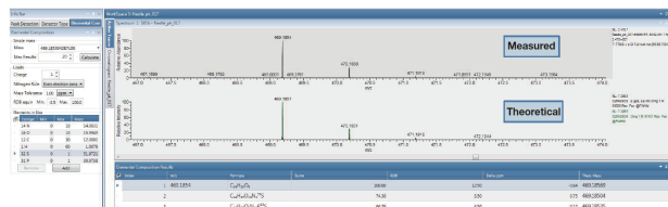
图 6. 包装样品中保留时间为 45.5 分钟的峰在元素组成计算器中的 FreeStyle 视图。基于准确质量和同位素分布信息, [M+H]^+ 离子的推测化学分子式为 C_{26}H_{28}O_8 。三个可能的化合物质量数差异在 1 ppm 以内, 其中最佳结果的同位素分布与理论分布的匹配度达到 100%。
