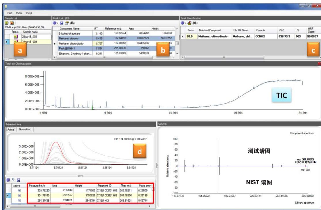
图 3. 二氯碘甲烷鉴定的解卷积结果界面，化合物鉴定基于标准谱库 (NIST) 正匹配搜索指标 (SI 963)、碎片离子合理化评价 HRF > 99% 和测试碎片离子的质量精度 (例如，分子离子  $m/z$  301.78513 质量偏差 = 0.23 ppm) 进行。样品处理 (a)、峰检测 (b)、鉴定化合物 (c) 和标明测试离子和理论离子及相关质量数偏差的二氯碘甲烷的解卷积质谱图 (d)。
