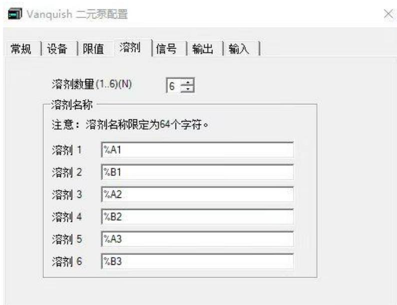
(该图来自 Q Exactive Plus 软件截图，证明超高效液相的每个泵能独立选择 3 个流路之一)
