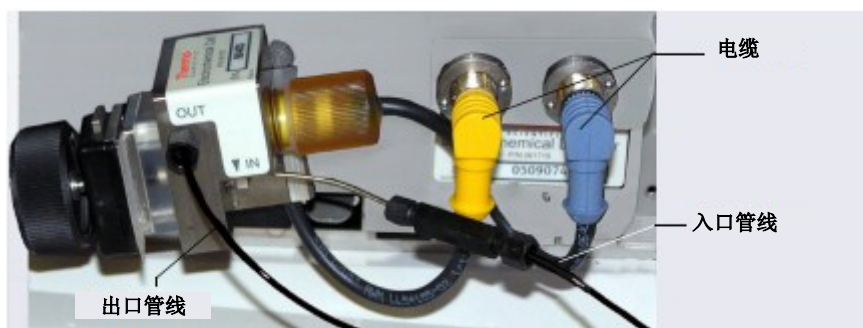
图 10-59. 断开 ED 池的连接（分析型 IC 配置用 ED 池如图所示）
