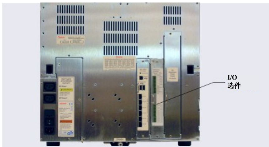
图 10-40. DC 后面板：已安装的 I/O 选件
