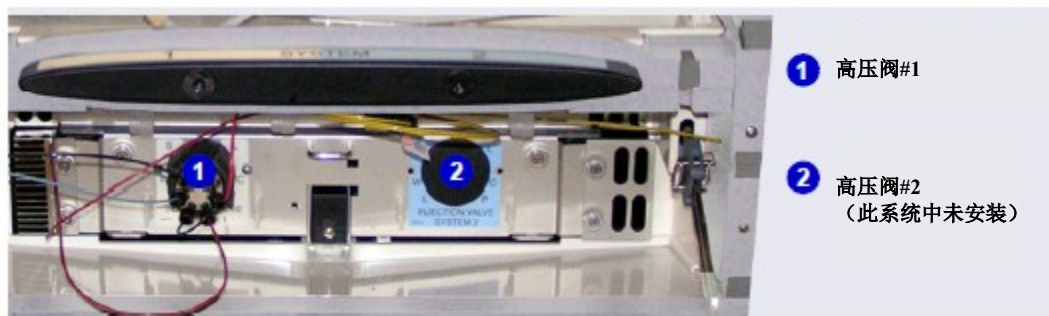
图 9-5. 高压阀#1 和#2 (DC 下间室中)
