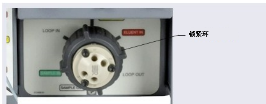
图 10-37. 拧松锁紧环 (IC Cube 中的阀如图所示)
