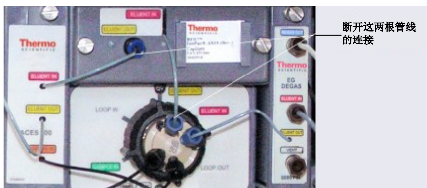
图 10-48. 断开毛细管托盘淋洗液管线的连接（电导率系统管路连接如图所示）
