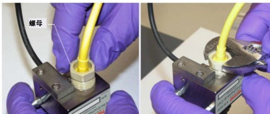
图 10-76. 安装 PdH 参比电极螺母
