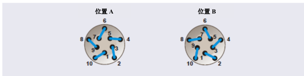
图 2-42. 高压开关阀流路示意图：十通阀
