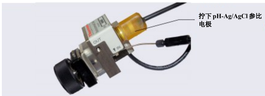
图 10-63. 拆除 pH-Ag/AgCl 参比电极（分析型 IC 配置用 ED 池如图所示）
