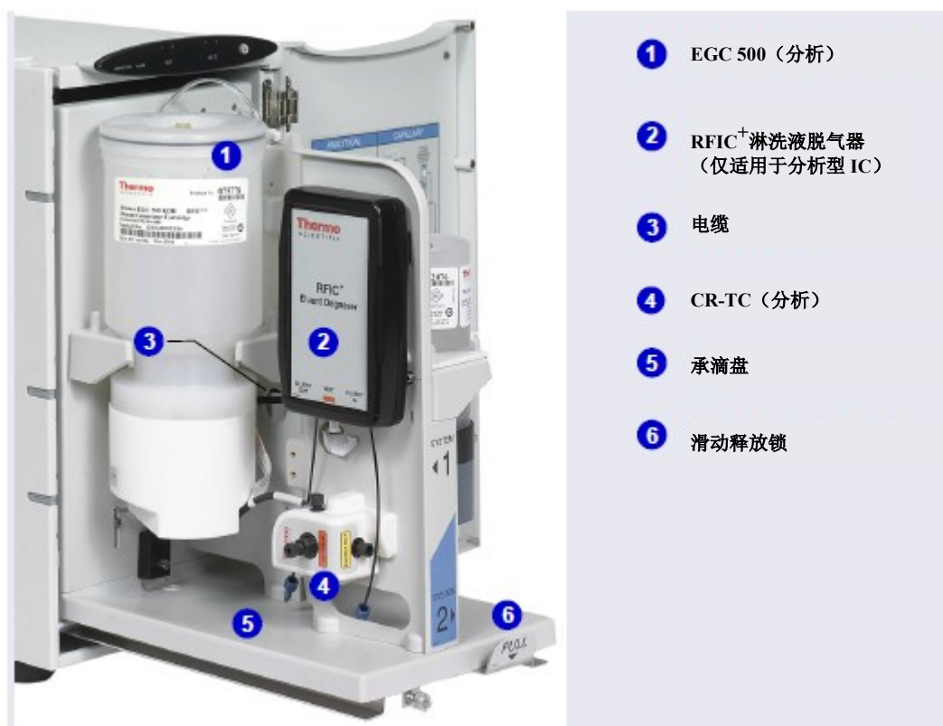
图 2-11. 分析（高压）IC 系统（系统 1 如图所示）EG 内部部件示例
