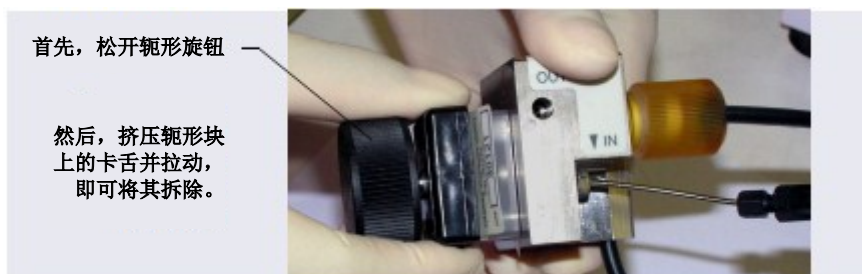
图 10-60. 拆卸 ED 池（分析型 IC 配置用 ED 池如图所示）
