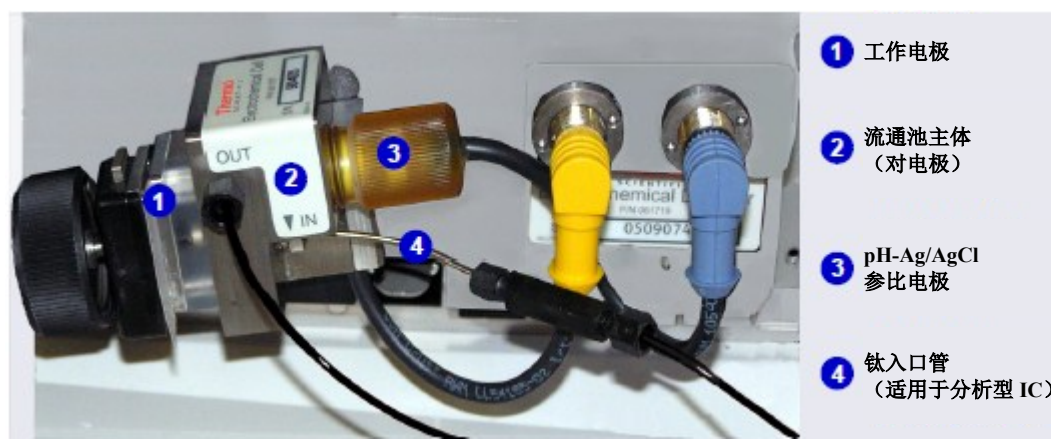
图 2-31. 带有 pH-Ag/AgCl 参比电极的 ED 池 (检测池采用所示分析型 IC 配置)
