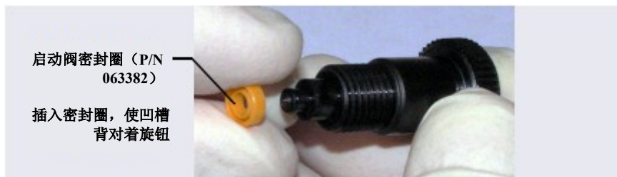
图 10-13. 更换灌注阀密封圈
