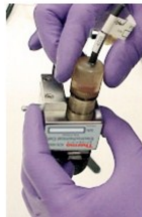
图 10-67. 将pH-Ag/AgCl参比电极安装到参考电极孔中
