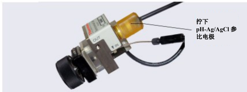
图 10-69. 拆除 pH-Ag/AgCl 参比电极（分析型 IC 配置用 ED 池如图所示）
