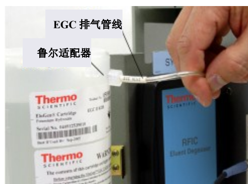
图 10-17. 分析 Dionex EGC 排气管线（标准压力盒如图所示）
