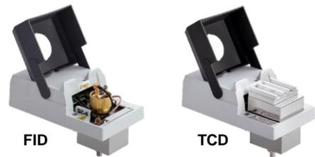
TRACE 1600 系列 GC 可容纳两个 iConnect 进样口和两个 iConnect 检测器，以及一个质谱仪。当 GC 配置 Thermo Scientific TRACE 1600 辅助柱温箱时，最多可同时连接四个 iConnect 检测器和一个质谱仪。
