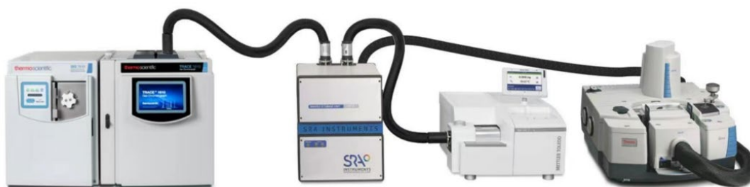
图 4 TGA -GCMS-FTIR 联用（并联模式）
