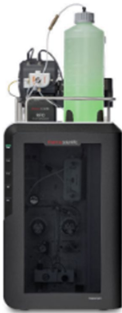
图 4 Dionex Inuvion with RFIC 高压离子色谱(EG 耐压至 5000psi, 兼容多步梯度)
