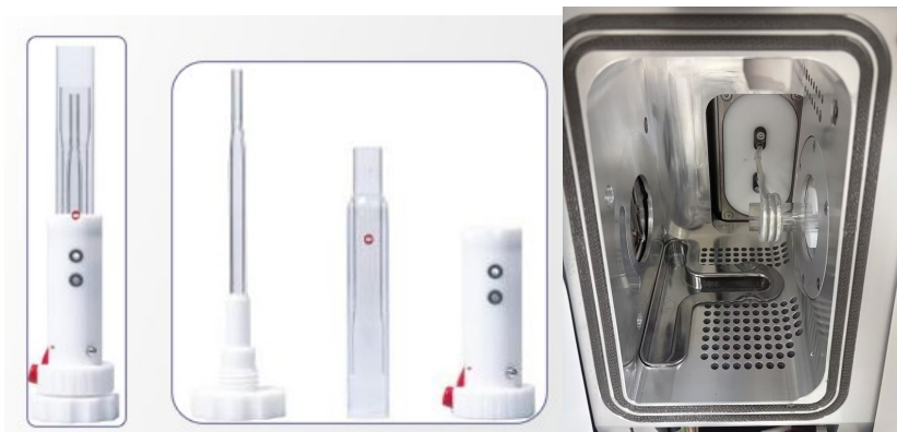
炬室及炬管照片，无屏蔽炬设计
