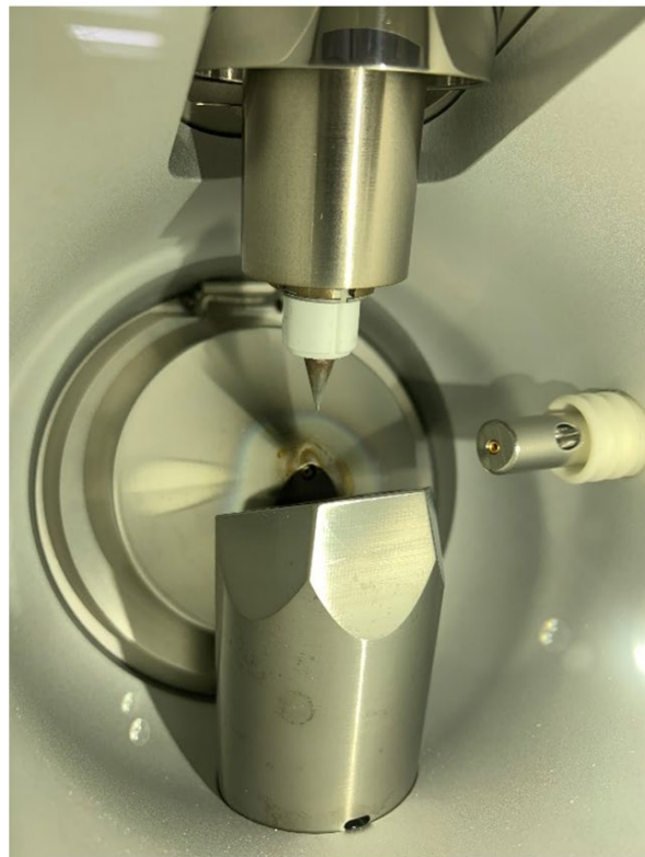
(该图为离子源照片，显示了底部设计有废液出口， 雾化后废产物直接进入废液出口 ，确保离子源腔体洁净) ←
