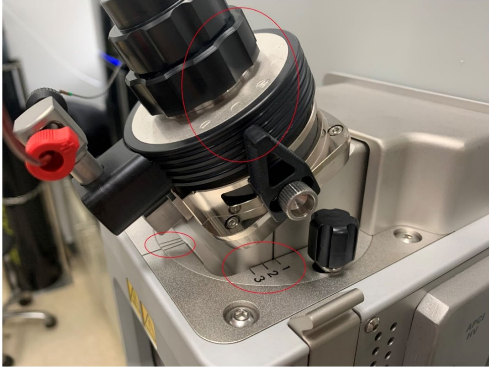
(该图为 OE 240 离子源照片，显示了 喷针前后“1/2/3” ，左右，上下“L/M/H”三维可调，方便对喷雾条件进行优化) ←
